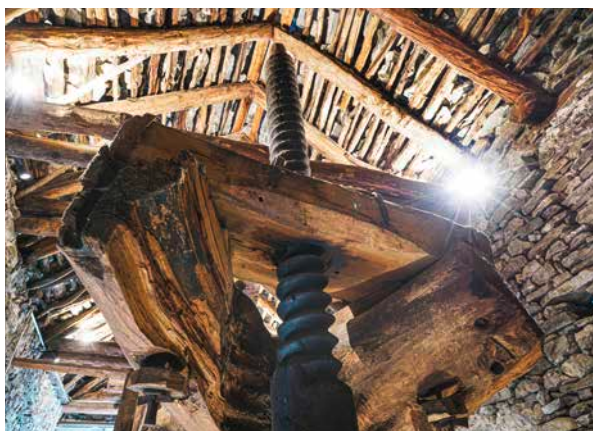
Il torchio a leva di Cavigliano: particolare della vite e della madre vite, particolare del letto in pietra con la data «1792» (da E. Riva, «I torchi a leva del Ticino» cit.)
