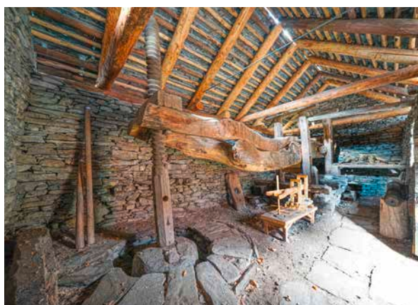
Il torchio a leva, datato 1580, di Cevio Bosco: vedute dell'esterno e dell'interno della sala, con il modellino dello stesso torchio (da E. Riva, «I torchi a leva del Ticino» cit.)
