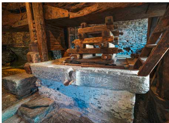
Il torchio a leva di Cavigliano: particolare della vite e della madre vite, particolare del letto in pietra con la data «1792» (da E. Riva, «I torchi a leva del Ticino» cit.)
