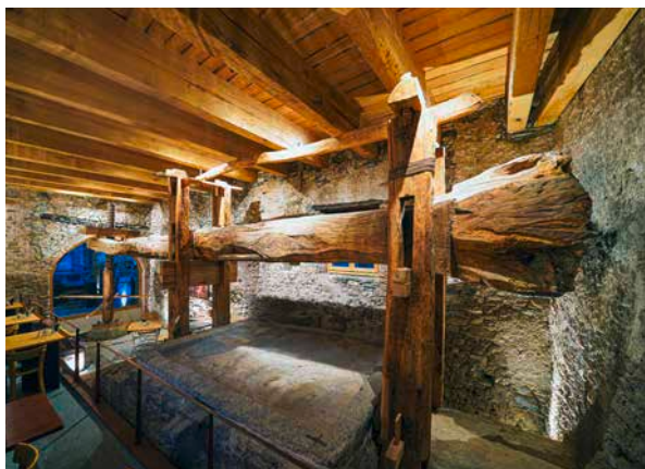
Il torchio a leva della Masseria di Cornaredo, con la data «1804» incisa sull'albero di quasi undici metri, il più lungo del Ticino (da E. Riva, «I torchi a leva del Ticino» cit.)
